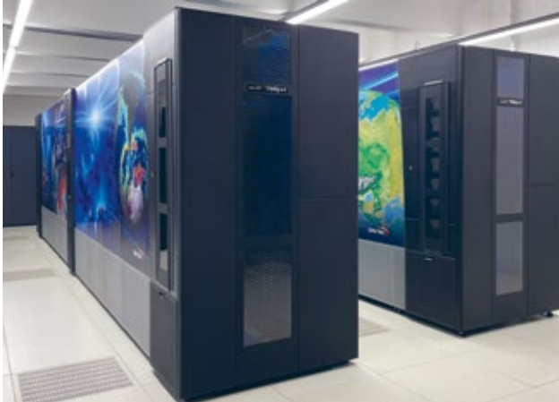
Abb.1: Die zwei neuen Magnetbandbibliotheken vom Typ Spectra Logic Tfinity.
