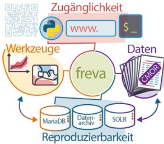
Abb. 1: Die vier Säulen von Freva: Zugänglichkeit (über das Web, die Kommandozeile und das Python-Modul), Datenzugang (standardisiert nach CMOR-Standards), Analysewerkzeuge (von Wissenschaftlern programmiert, leicht mit Freva zu verbinden), Reproduzierbarkeit (MariaDB-Server für historische Läufe, SOLR-Server für Datenzugriffspunkte, Dateisystem, in dem die Ergebnisse gespeichert werden).
