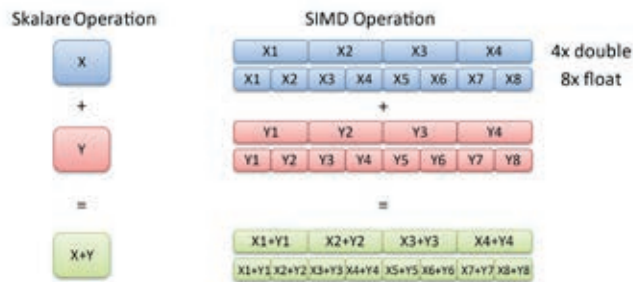
Abb. 2: Durch die Reduktion von doppelter (double) auf einfache Genauigkeit (float) kann die Anzahl paralleler Operationen verdoppelt werden.
