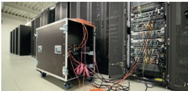
Abb. 2: Die NetApp wurde über einen zentralen Netzwerk-Switch an das HPC-System am DKRZ angeschlossen.
