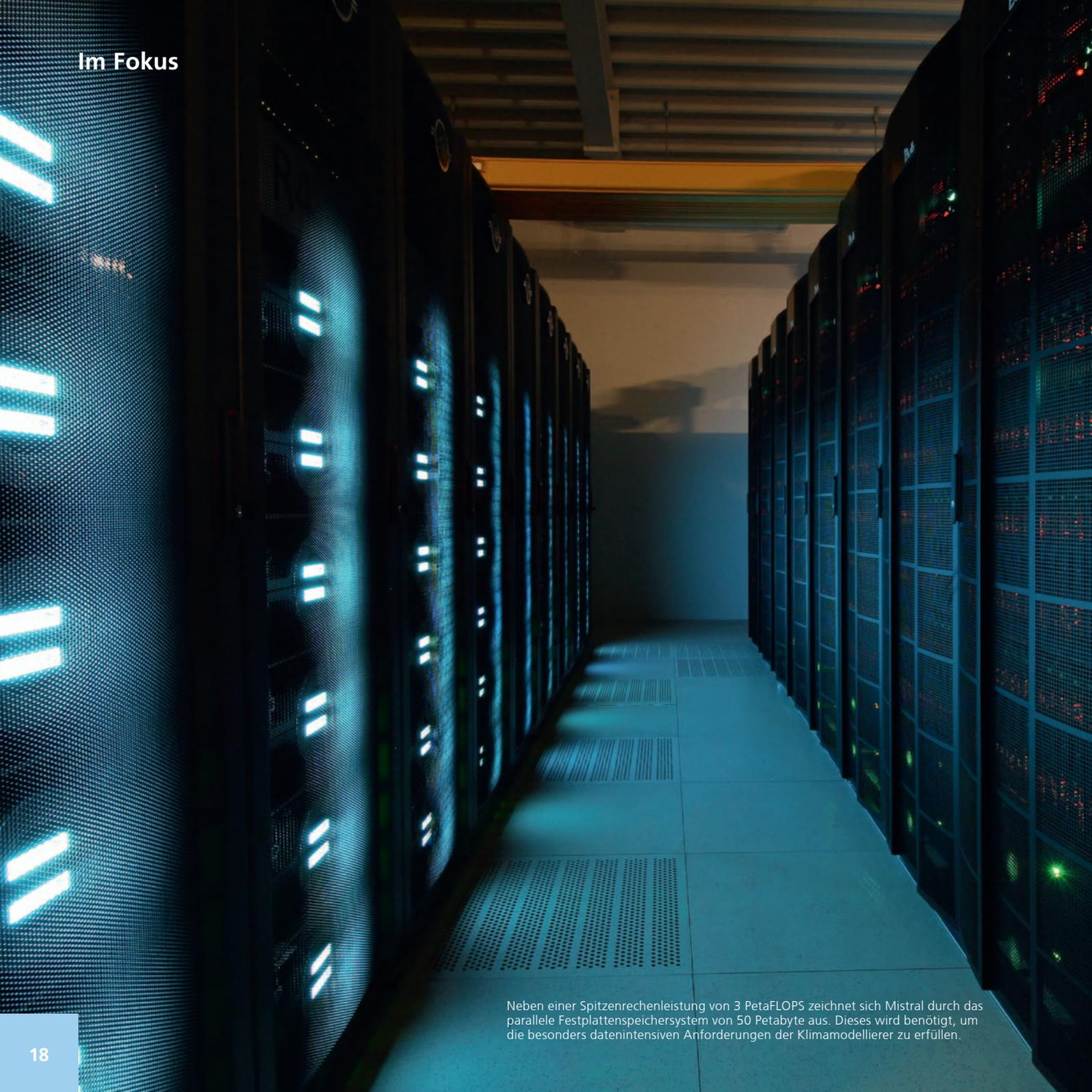
Neben einer Spitzenrechenleistung von 3 PetaFLOPS zeichnet sich Mistral durch das parallele Festplattenspeichersystem von 50 Petabyte aus. Dieses wird benötigt, um die besonders datenintensiven Anforderungen der Klimamodellierer zu erfüllen.
