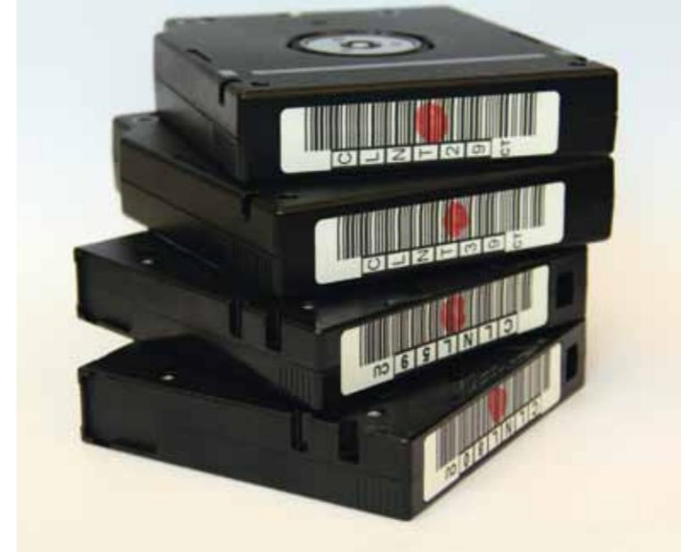
Abb. 1: Zur Langzeitarchivierung von Klimadaten werden Magnetbandkassetten eingesetzt.
