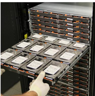
Im Dezember 2014 wurde das Archivsystem mit Intel-x86-Hardware und der neuesten HPSS-Software aufgerüstet. Es stehen nun als Steuerungseinheiten zwei redundante HPSS-Core-Server und fünf Tapemover zur Verfügung. Anfang März wurde der Festplatten-cache nochmals erweitert und bietet mit 5 Petabyte die zehnfache Kapazität des alten Systems.
